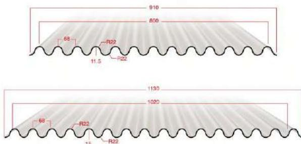
این محصول براساس نوع سازه و همچنین کاربردی که دارد، بنا به درخواست مشتری بر روی ورق گالوانیزه از ضخامت ۰/۹۵ میلی‌متر و همچنین ورق رنگی از ضخامت ۰/۲۵ تا ۰/۶۰ میلی‌متر و عرض ۱۰۰ و ۱۲۵ میلی‌متر انجام می‌شود.
